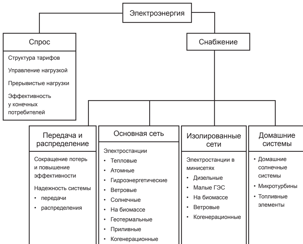
Рис. 1.1. Схема вариантов электроснабжения
